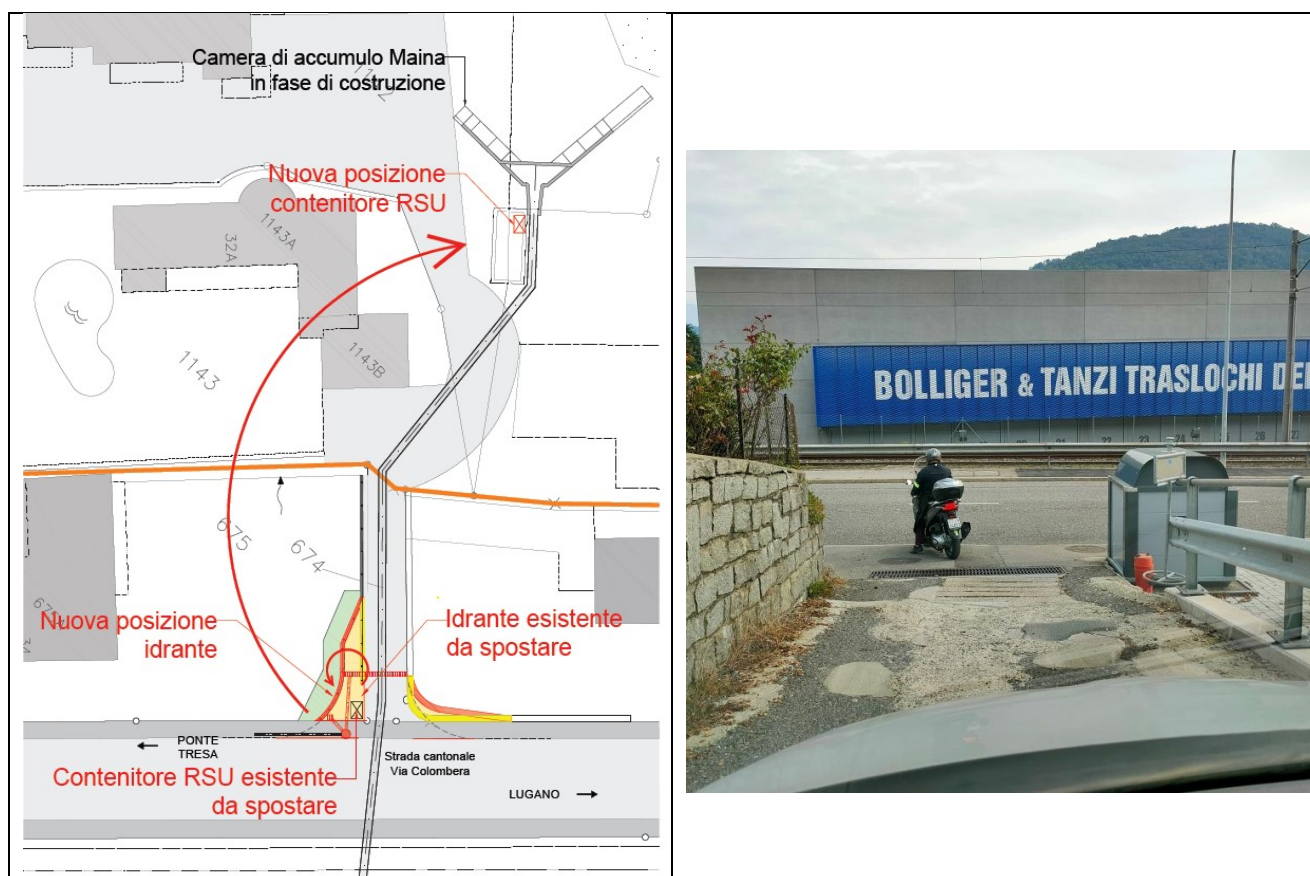
Figura 13: Posizione contenitore RSU e idrante e proposta nuova posizione.
